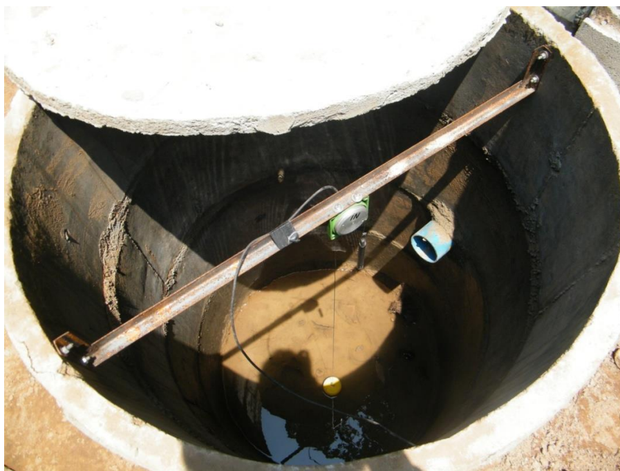
ภาพที่ 7 ชุดเครื่องมือวัดระดับน้ำอัตโนมัติในบ่อน้ำนิ่งอันประกอบด้วยลูกลอย (สีเหลือง) และ sensor วัดระดับน้ำซึ่งบรรจุอยู่ในกล่องโลหะสีเขียว
